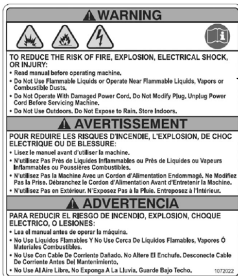
ÉTIQUETTE D'AVERTISSEMENT - (p/n 1072022) Apposée sur la partie arrière de la poignée de commande.
